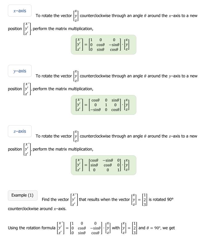
$$\begin{bmatrix} x'\\y'\\z' \end{bmatrix} = \begin{bmatrix} 1 & 0 & 0\\0 & \cos\theta & -\sin\theta\\0 & \sin\theta & \cos\theta \end{bmatrix} \cdot \begin{bmatrix} x\\y\\z \end{bmatrix} = \begin{bmatrix} 1 & 0 & 0\\0 & \cos90^\circ & -\sin90^\circ\\0 & \sin90^\circ & \cos90^\circ \end{bmatrix} \cdot \begin{bmatrix} 1\\2\\3 \end{bmatrix}$$
